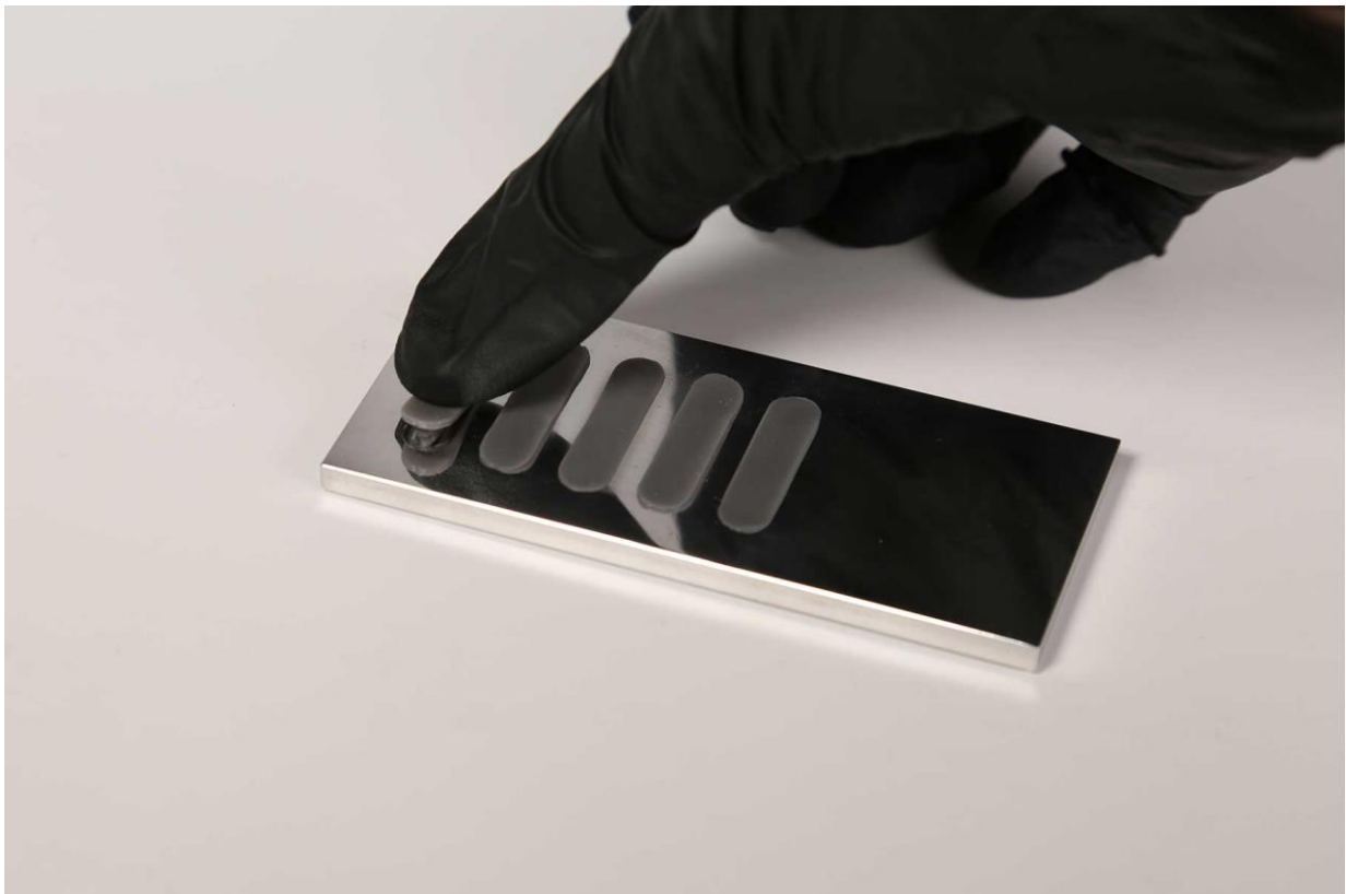
Masquage : Application des masques imprimés en 3D
