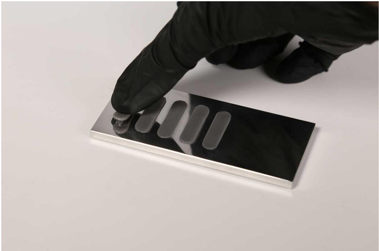
Masquage : Application des masques imprimés en 3D
